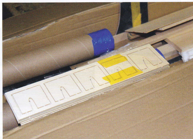
Schablonen erleichtern die Profilierung des Flügels.
